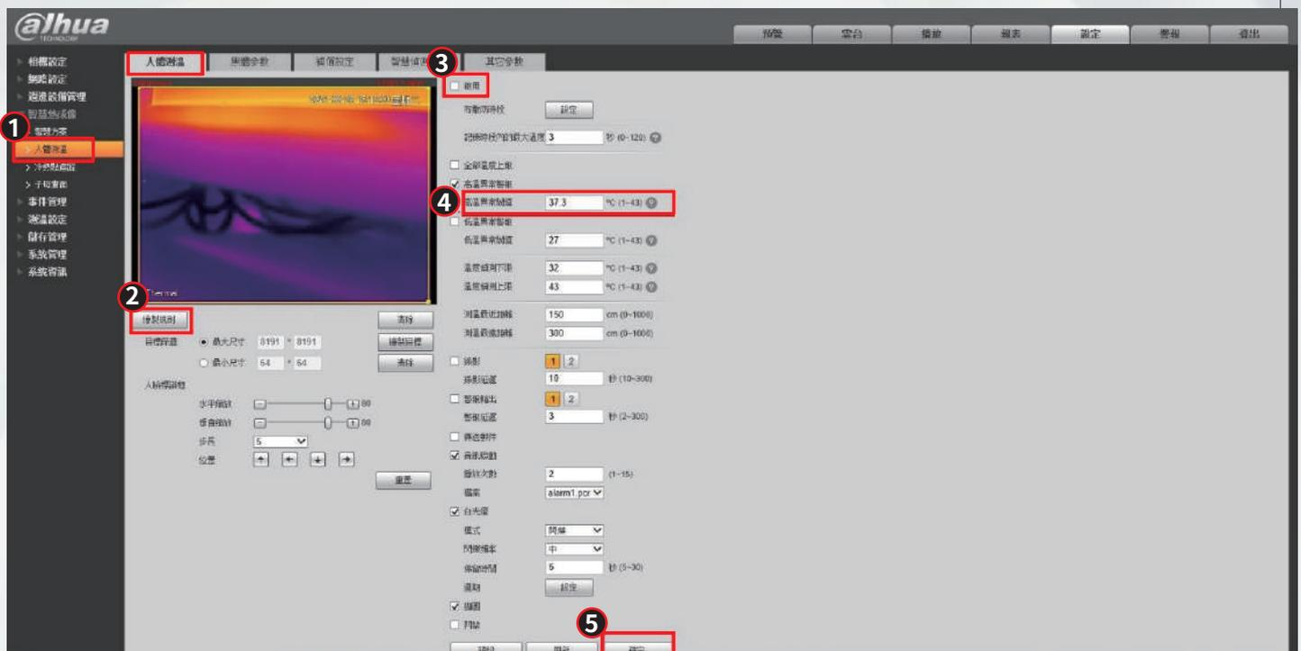
**STEP 4.** 點選「黑體參數」 > 點選「繪製區域」 > 輸入「測定黑體溫度」(與黑體上溫度一樣) > 勾選「啟用」 > 點選「確定」
