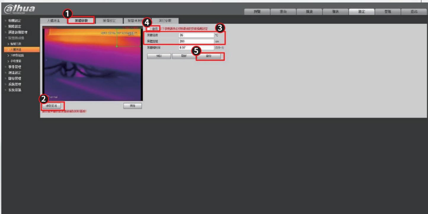
**STEP 5.** 點選「補償設定」> 點選「人體溫度校正」(如：現場溫度太高或太低可在這修正)> 點選「確定」
