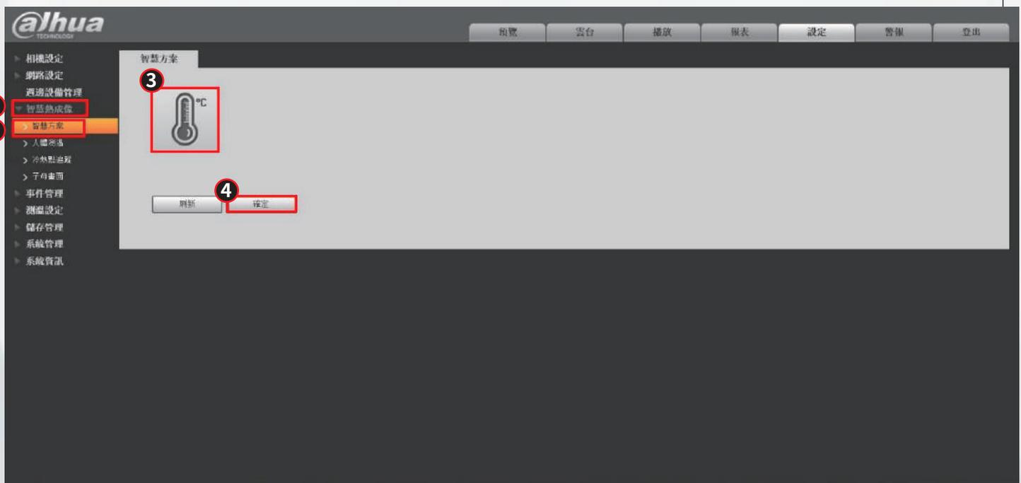
**STEP 3.** 點選「人體測溫」 > 點選「繪製規則」(繪製偵測區域大小) > 勾選「啟用」 > 設定「偵測溫度」 > 點選「確定」
